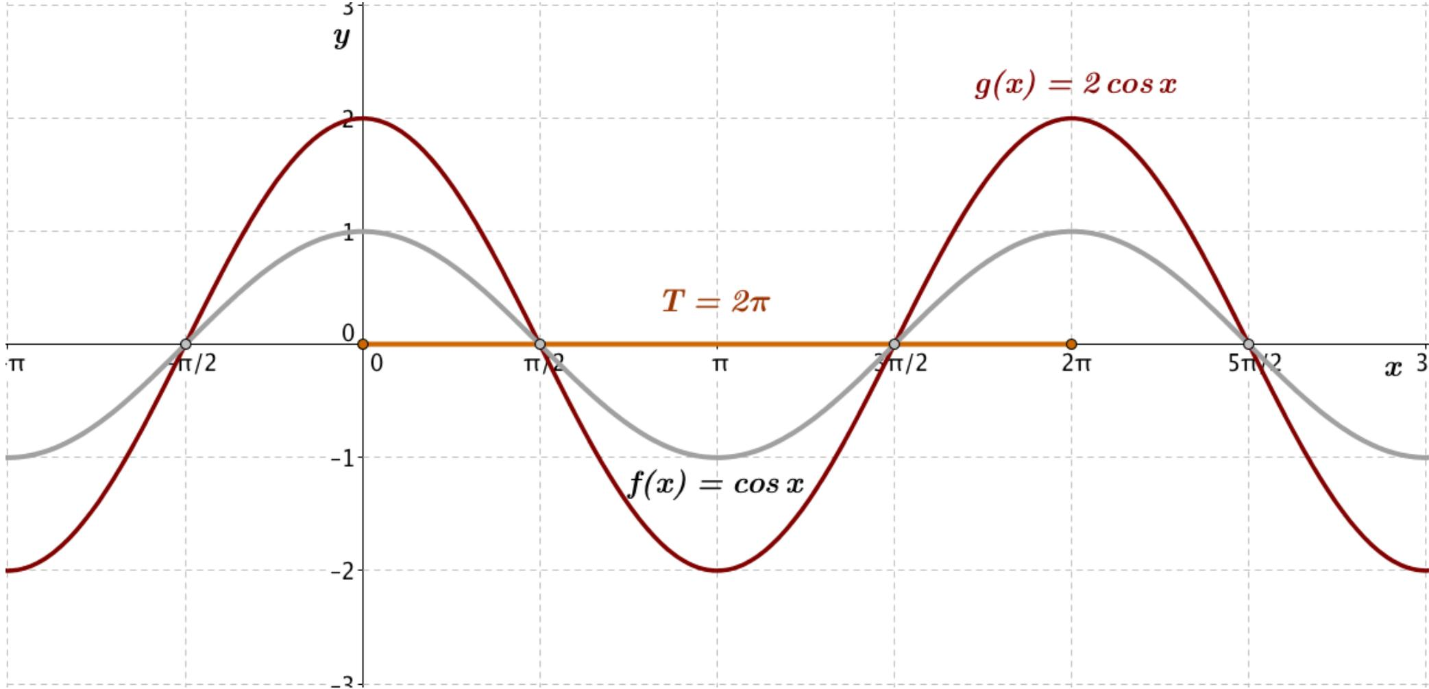
Abb. L1-1: Die Kosinusfunktionen  $f(x) = \cos x$  und  $g(x) = 2 \cos x$ . Man erhält den Graphen einer Funktion  $g(x)$ , indem man den Graphen der Funktion  $f(x) = \cos x$  in Richtung der y-Achse um den Faktor 2 streckt.
