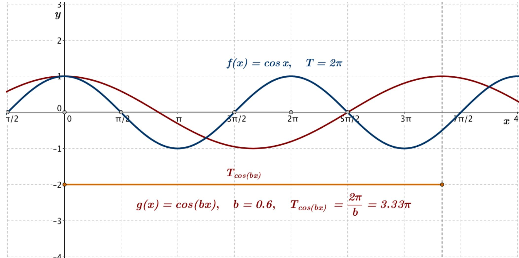
Abb. L2-3: Die Kosinusfunktionen  $f(x) = \cos x$  und  $g(x) = \cos(0.6x)$ . Man erhält den Graphen einer Funktion  $g(x)$ , indem man den Graphen der Funktion  $f(x) = \cos x$  in Richtung der  $x$ -Achse um den Faktor 0.6 streckt
