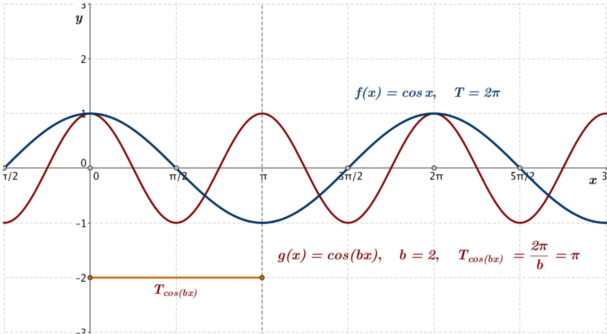
Abb. L2-1: Die Kosinusfunktionen  $f(x) = \cos x$  und  $g(x) = \cos(2x)$ . Man erhält den Graphen einer Funktion  $g(x)$ , indem man den Graphen der Funktion  $f(x) = \cos x$  in Richtung der  $x$ -Achse um den Faktor 2 streckt
