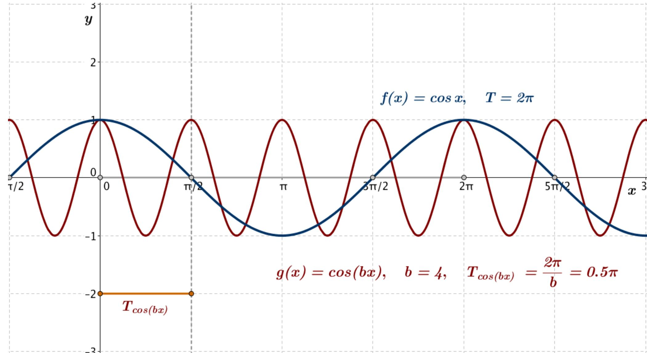
Abb. L2-2: Die Kosinusfunktionen  $f(x) = \cos x$  und  $g(x) = \cos(4x)$ . Man erhält den Graphen einer Funktion  $g(x)$ , indem man den Graphen der Funktion  $f(x) = \cos x$  in Richtung der  $x$ -Achse um den Faktor 4 streckt
