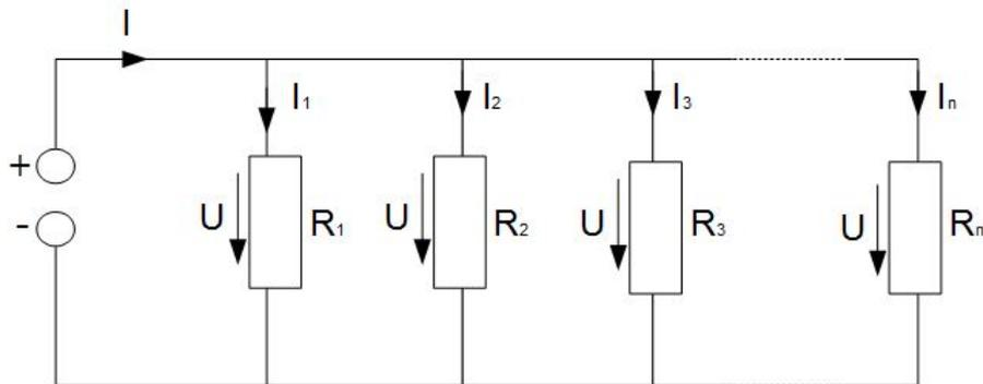
Abbildung 5: Die Parallelschaltung von Widerständen
