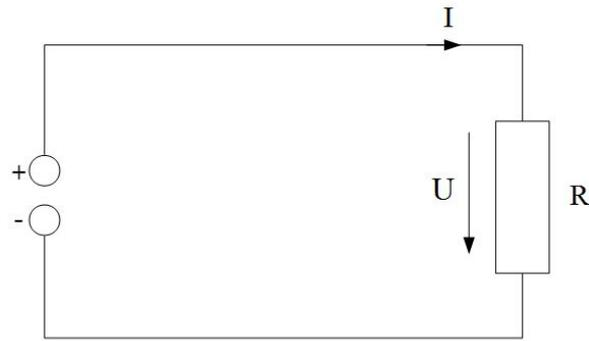
Abbildung 1: Der einfache Stromkreis
