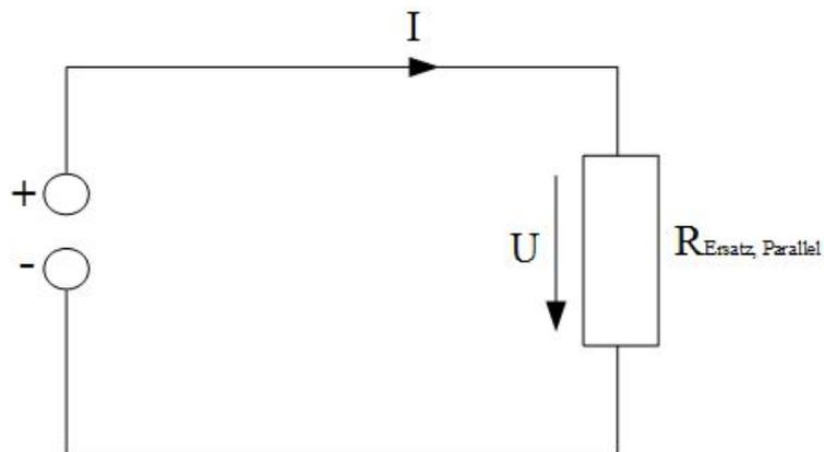
Abbildung 6: Ersatzstromkreis der Parallelschaltung
