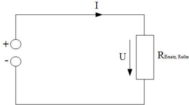
Abbildung 4: Ersatzstromkreis der Reihenschaltung
