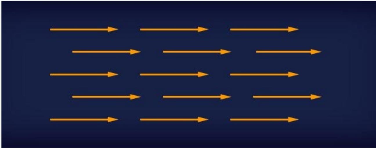
*Abb. 1: Homogenes elektrisches Feld in einem geladenen Plattenkondensator*
