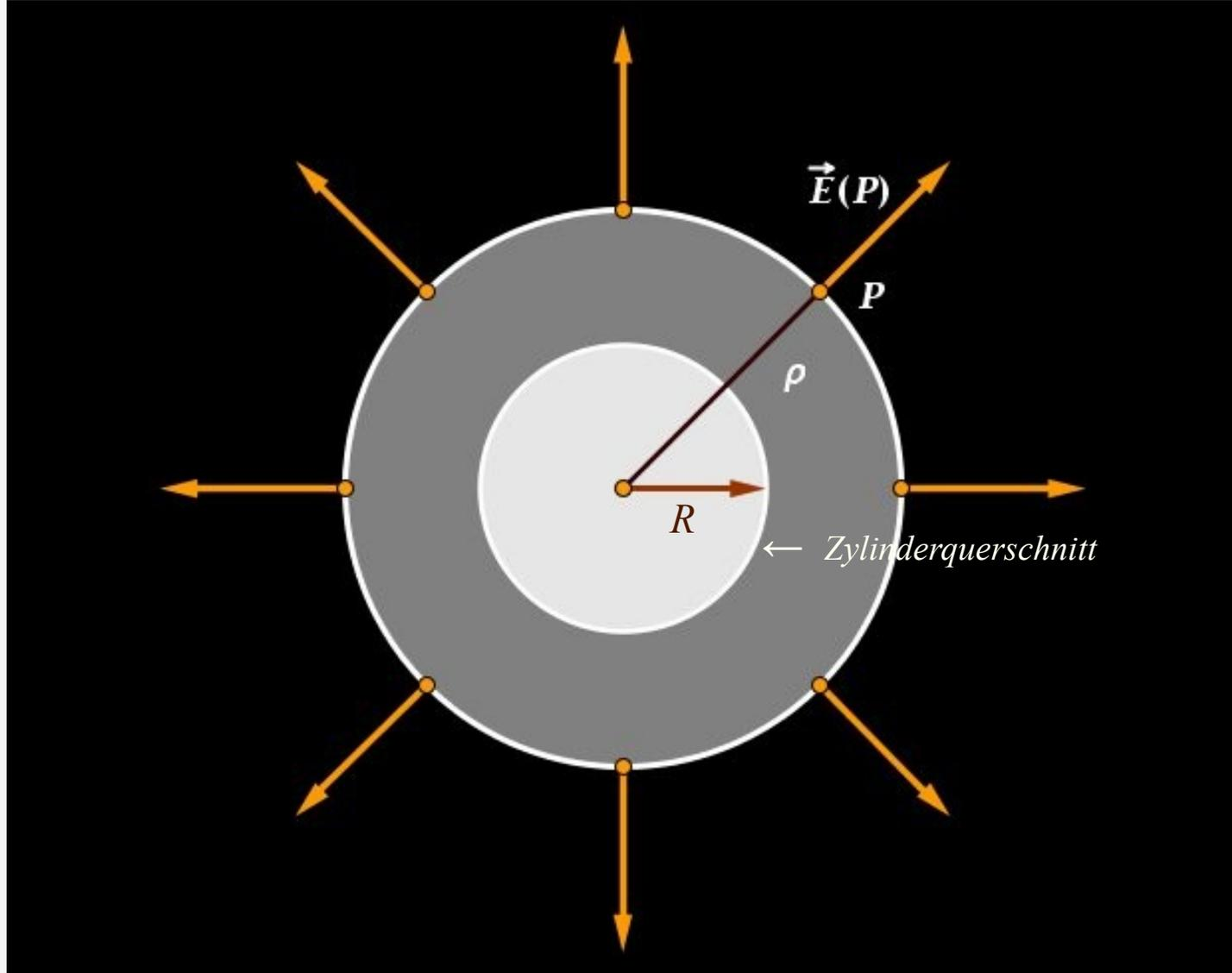
Abb. 5: Elektrisches Feld in der Umgebung eines homogen geladenen Zylinders (positive Ladungsdichte). Ebener Schnitt durch das Feld senkrecht zur Zylinderschse
