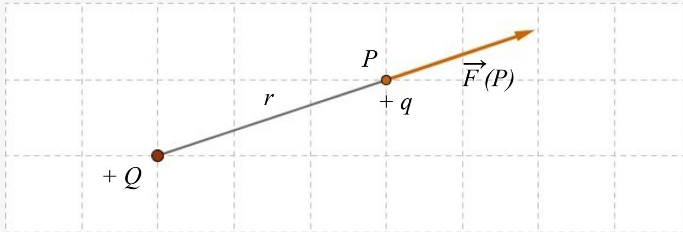
Abb. 1-1: Kraftwirkung auf eine positive Ladung
