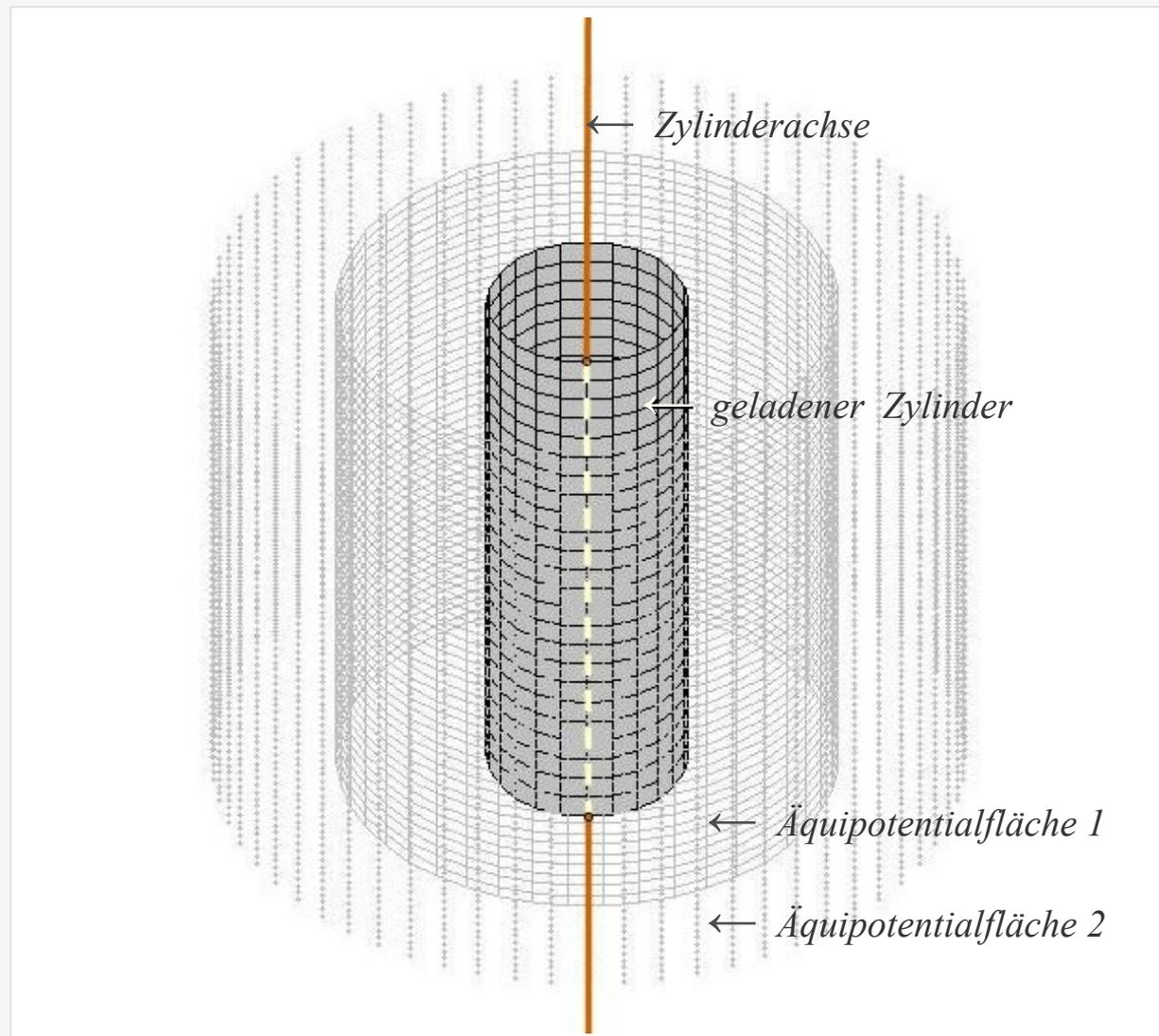
Abb. 2-3: Äquipotentialflächen eines geladenen Zylinders (koaxiale Zylindermäntel)
