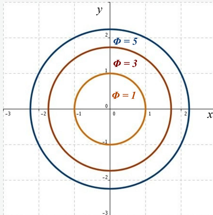
Abb. 3-2: Niveaulinien des ebenen Skalarfeldes  $\Phi = x^2 + y^2$ , die den Werten 1, 3, 5 entsprechen
