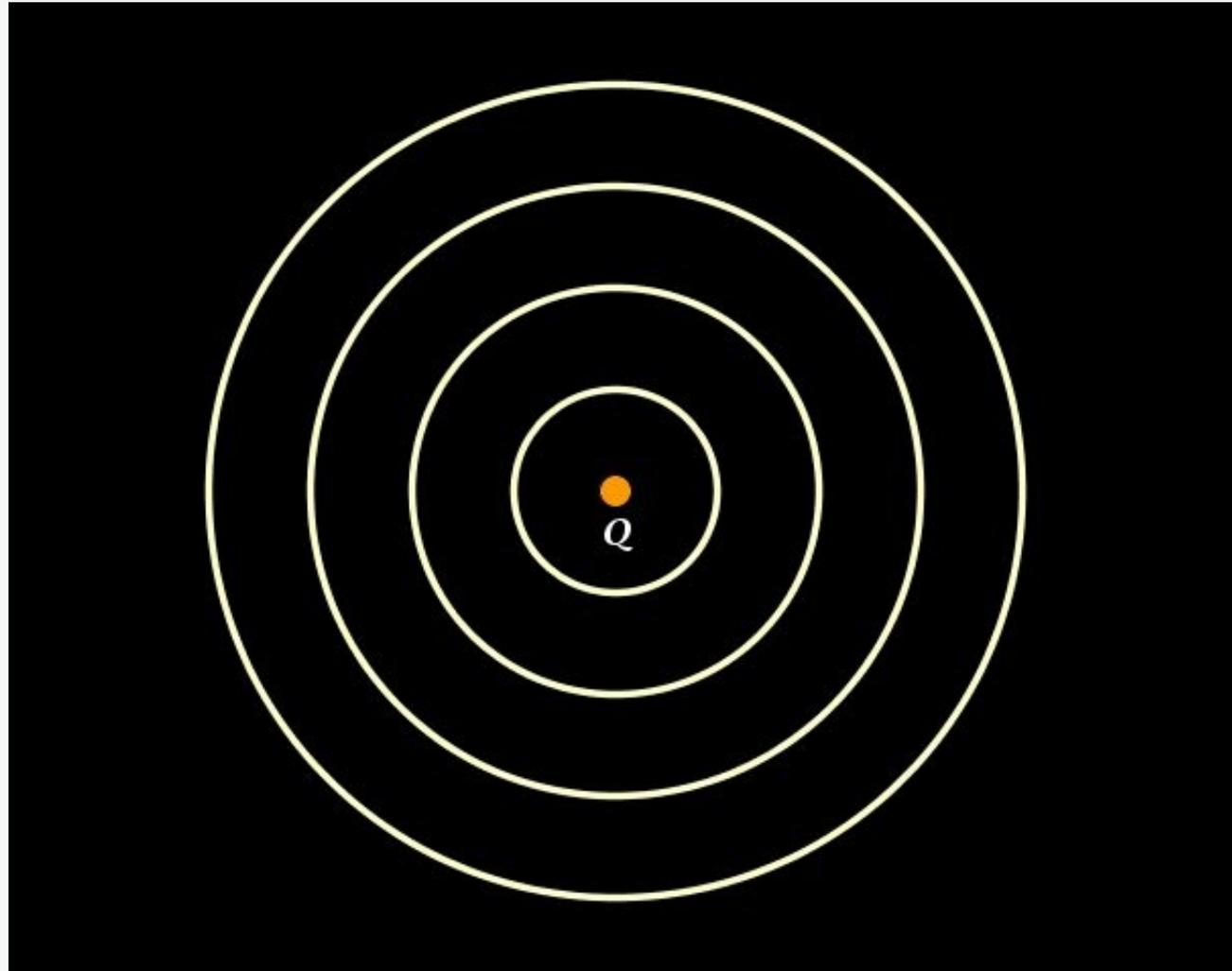
*Abb. 2-2: Äquipotentialflächen einer Punktladung (ebener Schnitt durch die Punktladung)*
