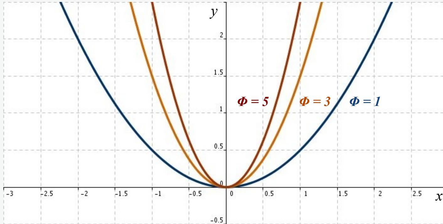
Abb. 3-3: Niveaulinien des ebenen Skalarfeldes  $\Phi = 2y/x^2$ , die den Werten 1, 3, 5 entsprechen
