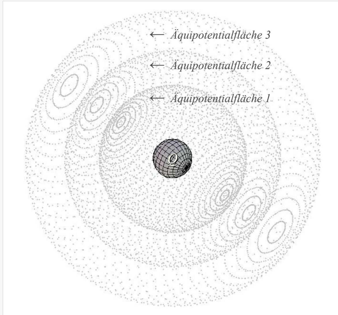
Abb. 2-1: Äquipotentialflächen einer Punktladung (konzentrische Kugelschalen).
