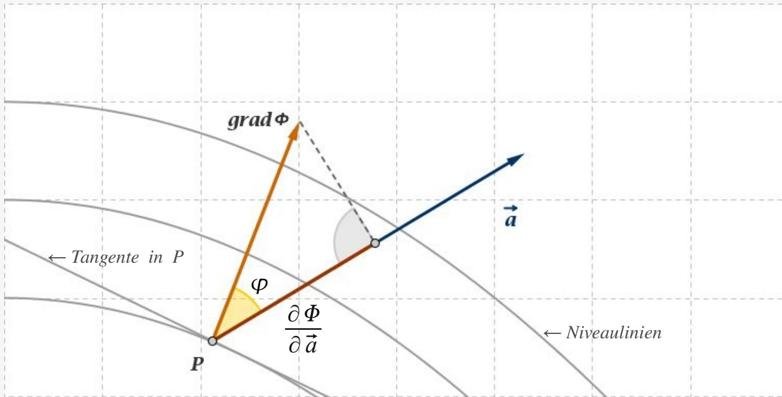
Abb. 2: Zum Begriff der Richtungsableitung eines skalaren Feldes
