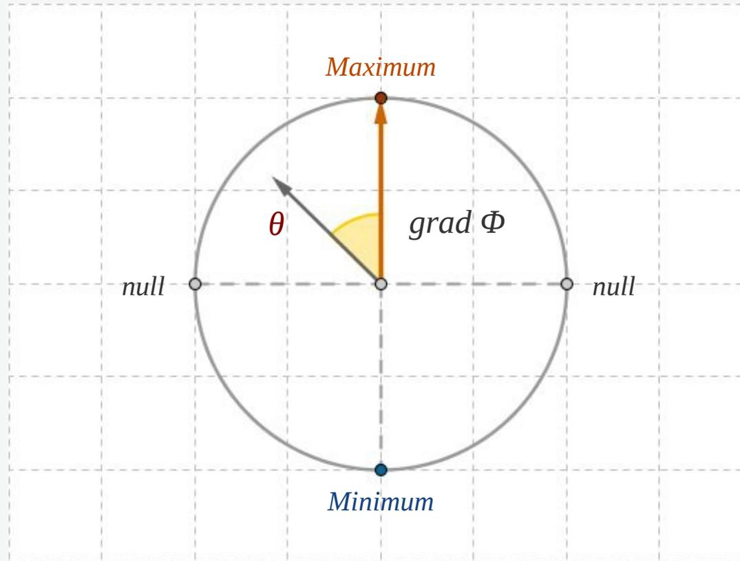
Abb. 3: Werte der Richtungsableitungen bei verschiedenen Winkeln des Gradienten
