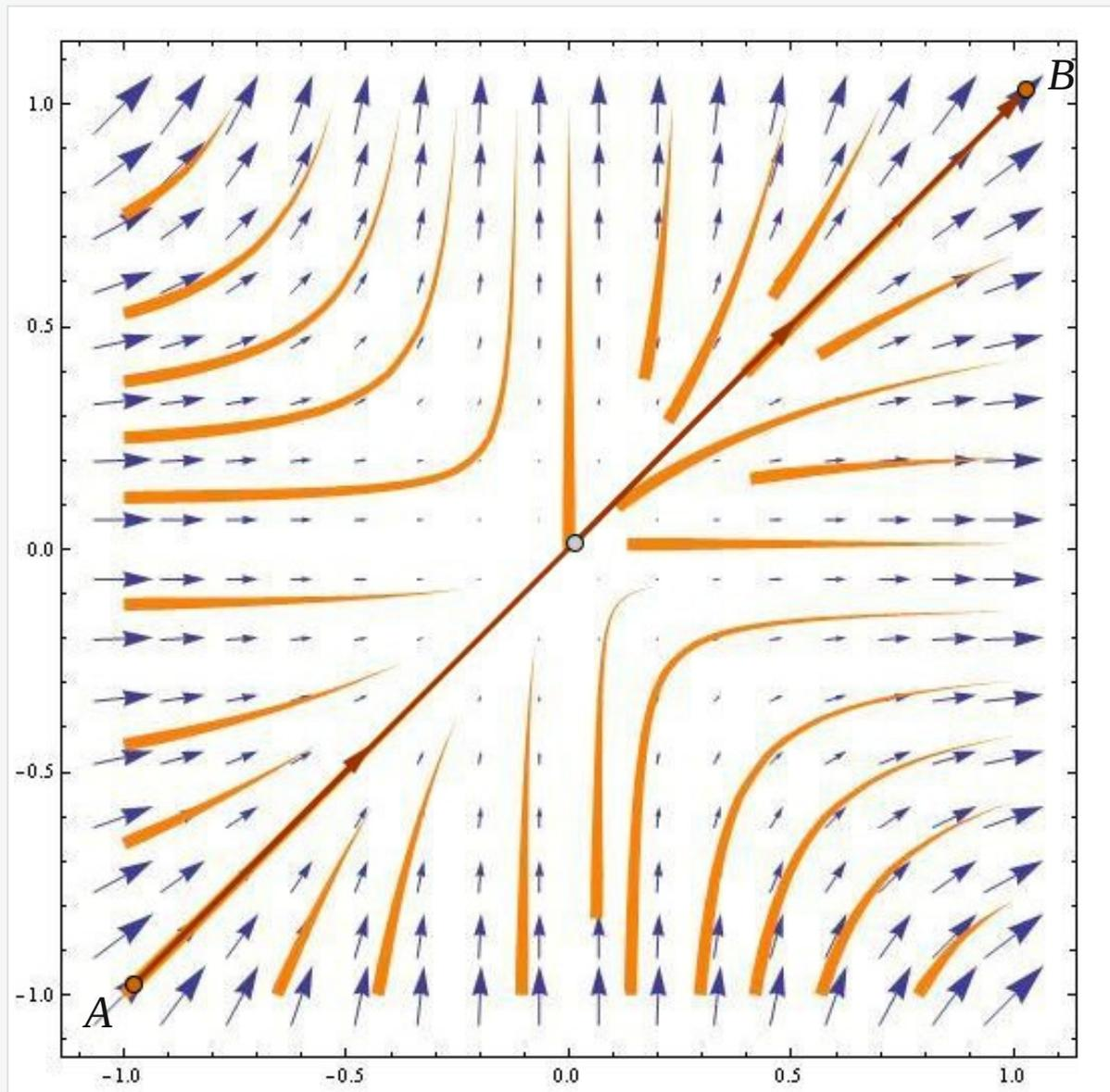
Abb. L-6b: Vektorfeld und Feldlinien der Funktion  $F(x, y) = (x^2, y^2)$ .
