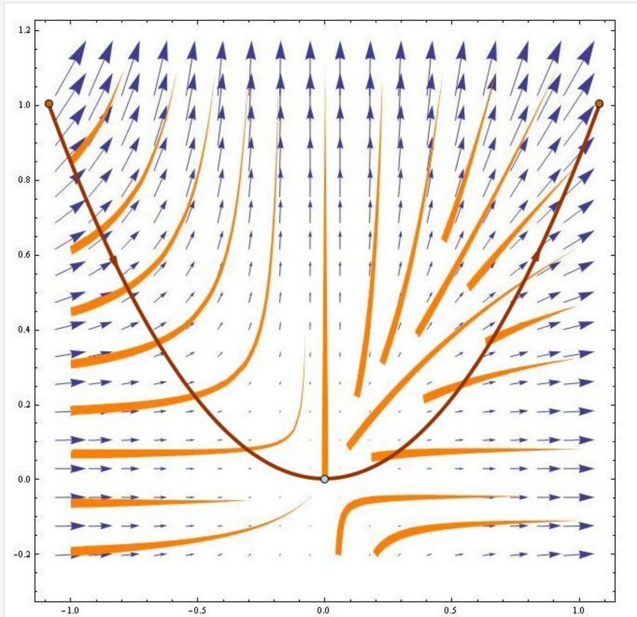
Abb. L-6d: Graphische Darstellung zur Aufgabe 6d: Vektorfeld und Feldlinien der Funktion  $F(x, y) = (x^2, y^2)$ . Kurve C: ein parabelförmiges Segment
