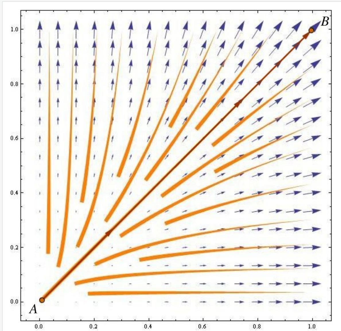
Abb. L-6a: Vektorfeld und Feldlinien der Funktion  $F(x, y) = (x^2, y^2)$ .
