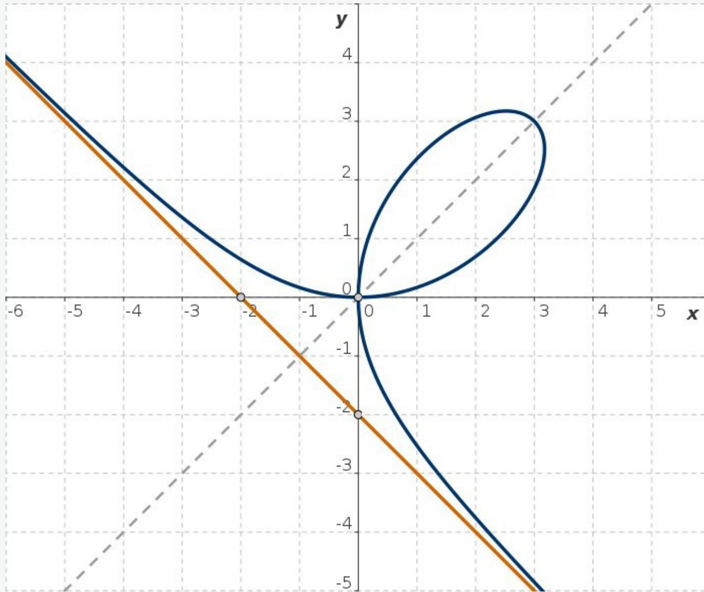
Abb. L21-1:  $\operatorname{div} \mathbf{F}(x, y)$  ist gleich Null längs der ebenen Kurve 3. Ordnung, dem kartesischen Blatt (vorgeschlagen von Konstantin Lühe)
