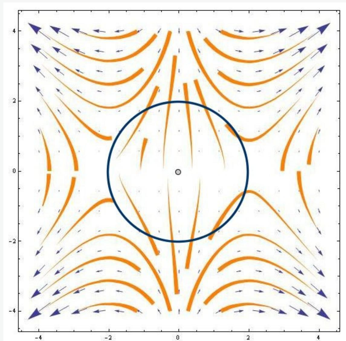
Abb. L18-2: Das Vektorfeld der Funktion  $\mathbf{F}(x, y) = (x y^2, x^2 y - 4y)$  und der Kreis mit dem Radius 2, längs dessen  $\operatorname{div} \mathbf{F}(x, y) = 0$
