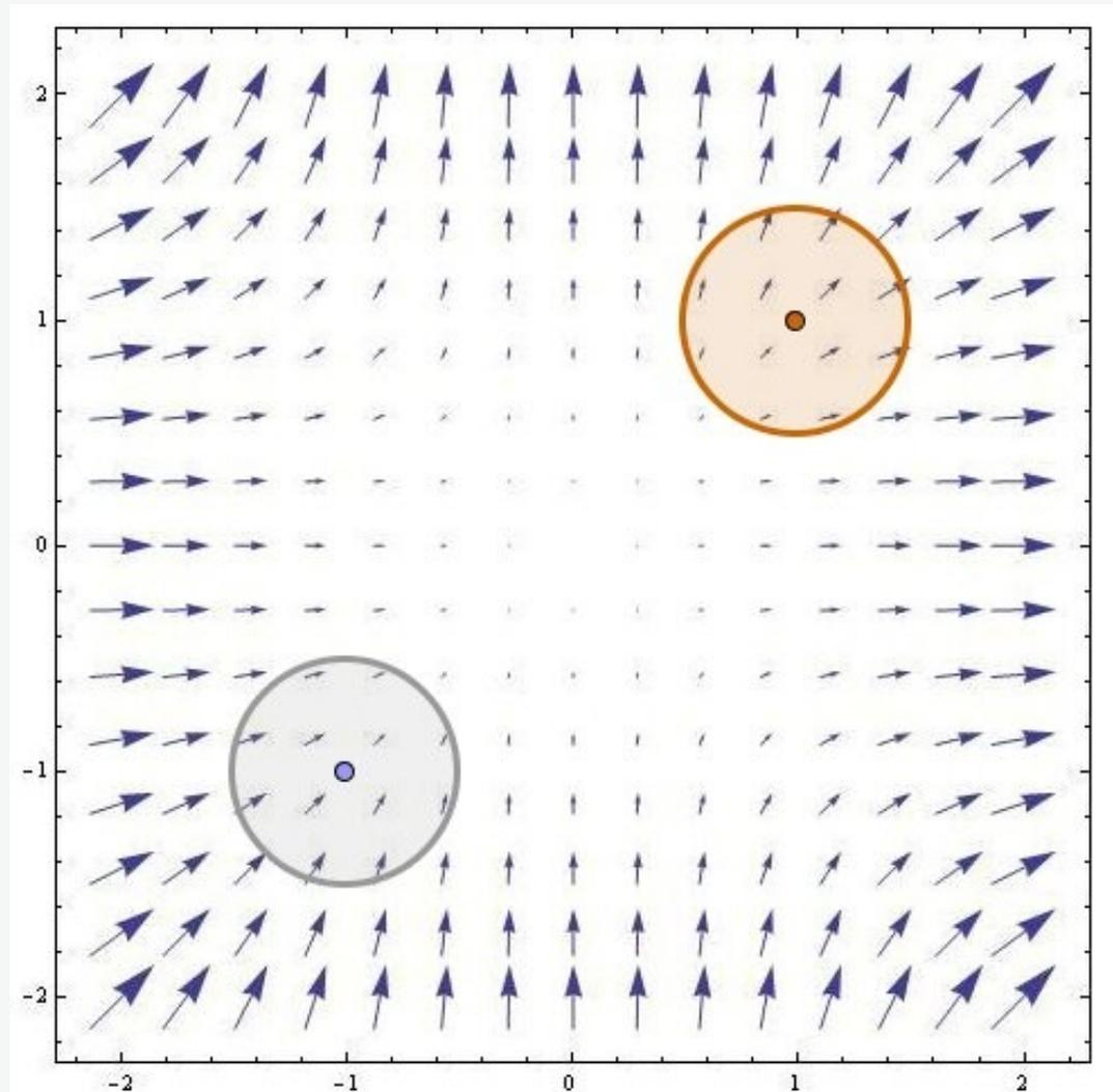
Abb. L4-1: Das Vektorfeld der Funktion  $\vec{F}(x, y) = (x^2, y^2)$
