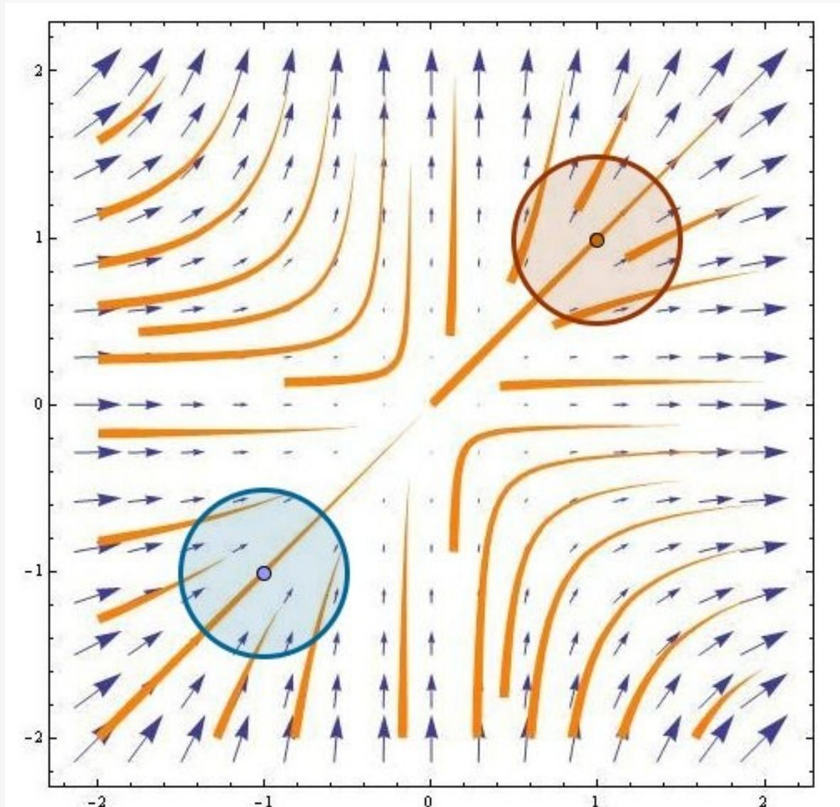
Abb. L4-2: Das Vektorfeld und Feldlinien der Funktion  $F(x, y) = (x^2, y^2)$
