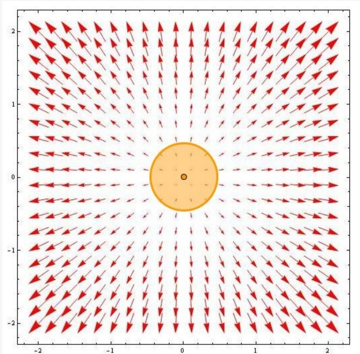
Abb. L5-1: Das Vektorfeld der Funktion  $\mathbf{r}(x, y) = (x, y)$
