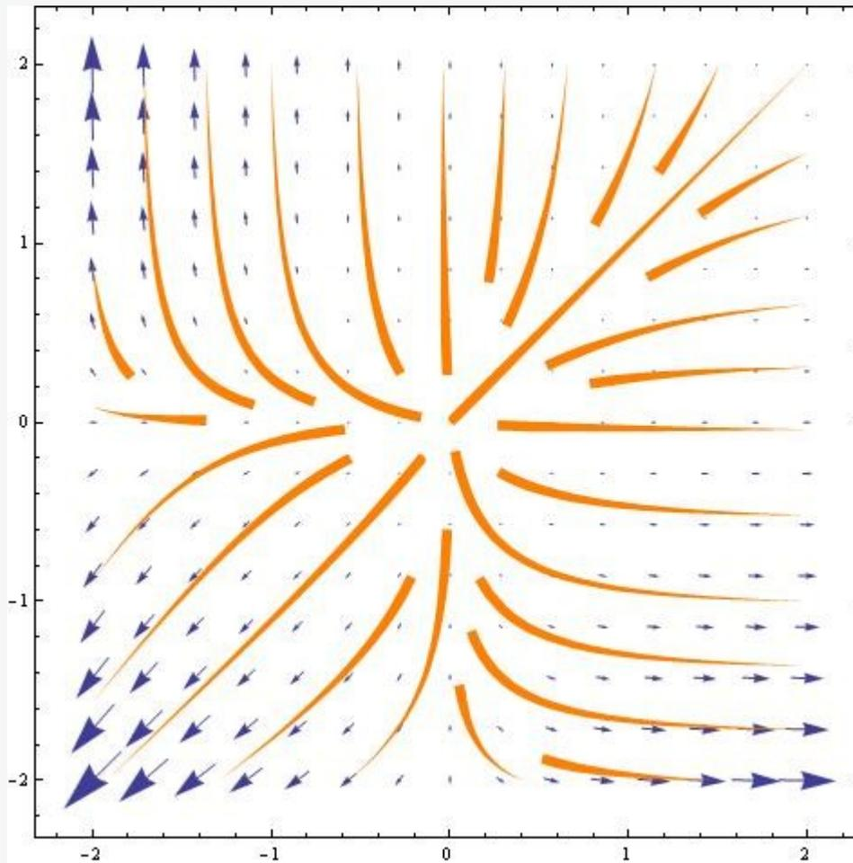
Abb. L7b: Vektorfeld und Feldlinien der Funktion  $\mathbf{F}(x, y) = (x \exp(-y), y \exp(-x))$
