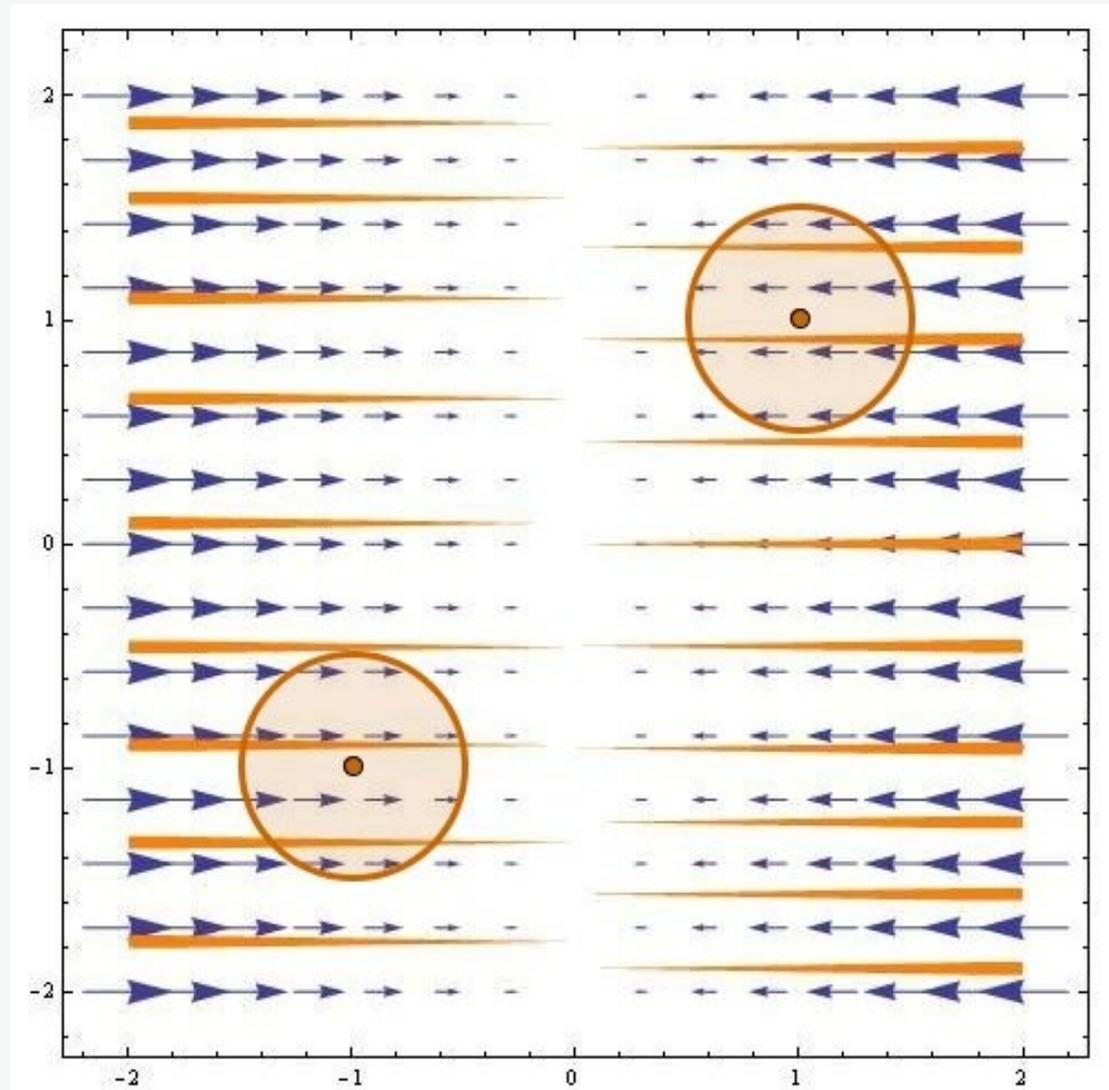
Abb. L2-2: Das Vektorfeld und Feldlinien der Funktion  $F(x, y) = (-x, 0)$
