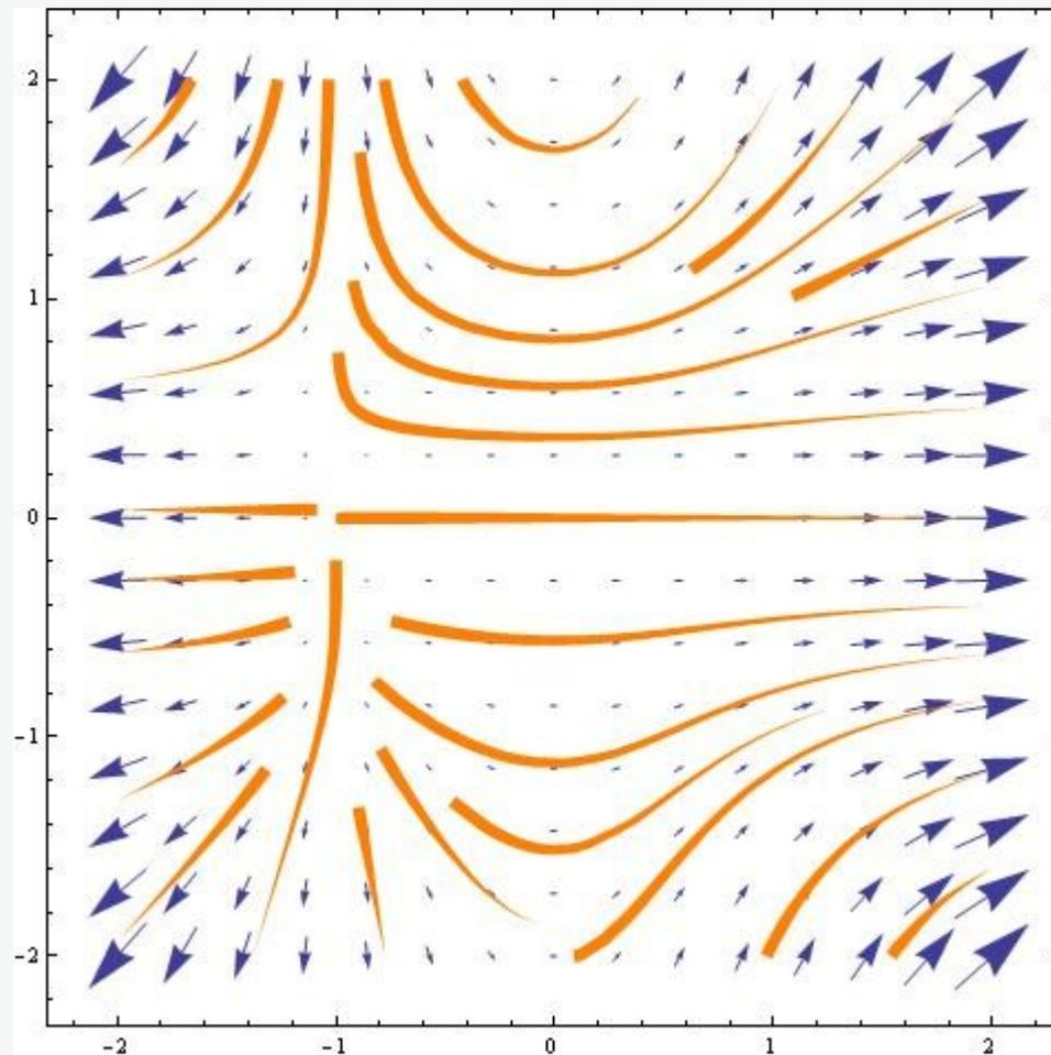
*Abb. L7a: Vektorfeld und Feldlinien der Funktion  $\mathbf{F}(x, y) = (x^3 + 1, xy^2)$*
