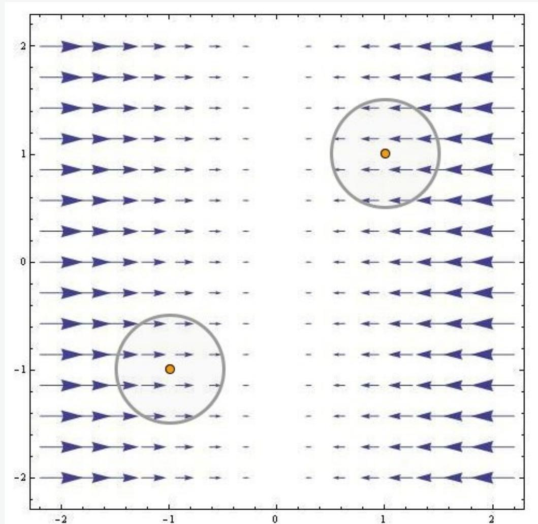
Abb. L2-1: Das Vektorfeld der Funktion  $F(x, y) = (-x, 0)$
