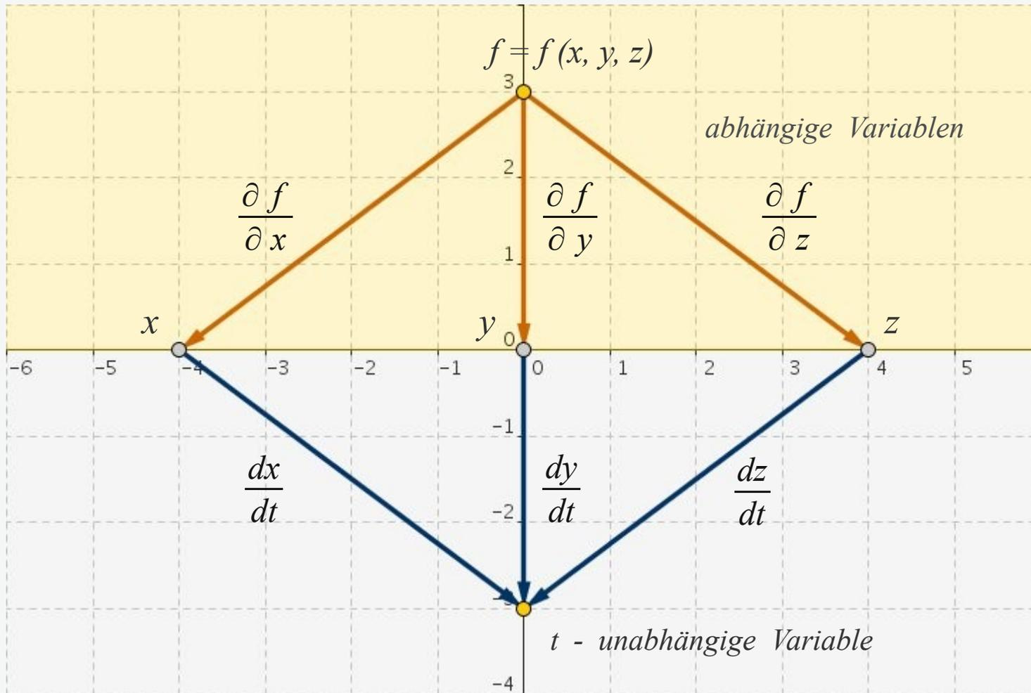
Abb. 1-3: Die Darstellung der Kettenregel für eine Funktion  $f = f(x, y, z)$  mit Hilfe eines Diagramms
