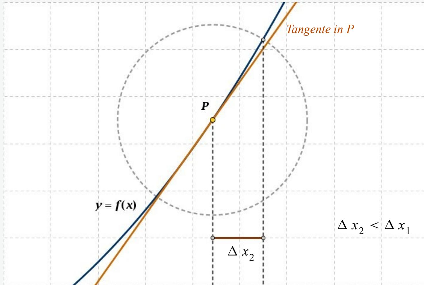
Abb. 3-3: Zum Begriff der lokalen Linearität einer Funktion  $y = f(x)$ . Die zweite Umgebung des Punktes  $P(x, f(x))$
