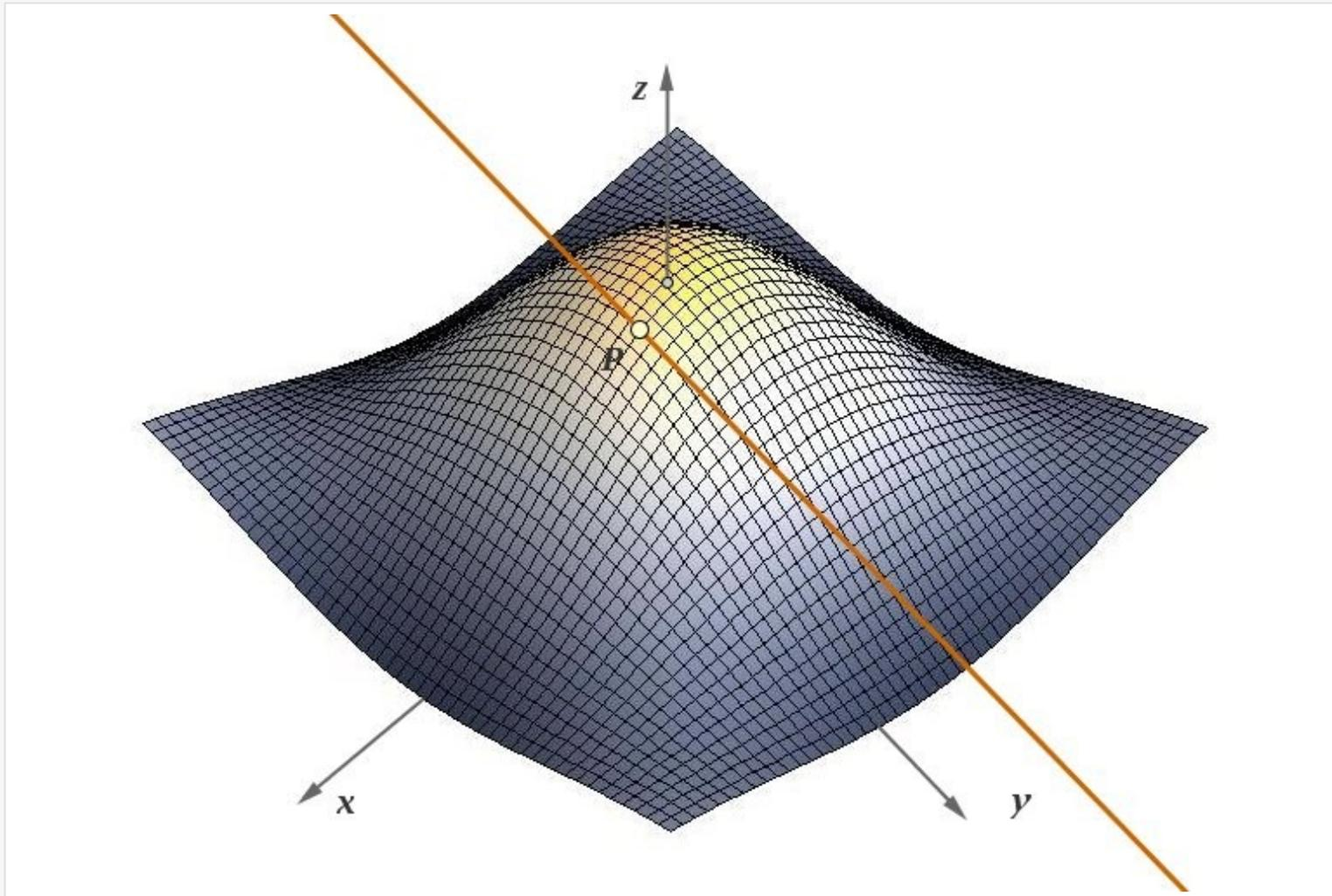
Abb. 1-2: Zum Begriff der partiellen Ableitung einer Funktion  $f = f(x, y)$  in  $y$ -Richtung. Die Tangente im Punkt  $P$  liegt in einer Ebene, die parallel zur  $y, z$ -Ebene verläuft
