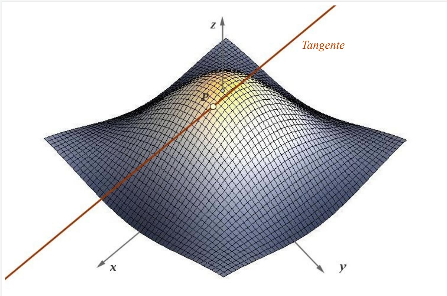
Abb. 1-1: Zum Begriff der partiellen Ableitung einer Funktion  $f = f(x, y)$  in  $x$ -Richtung. Die Tangente im Punkt  $P$  liegt in einer Ebene, die parallel zur  $x, z$ -Ebene verläuft
