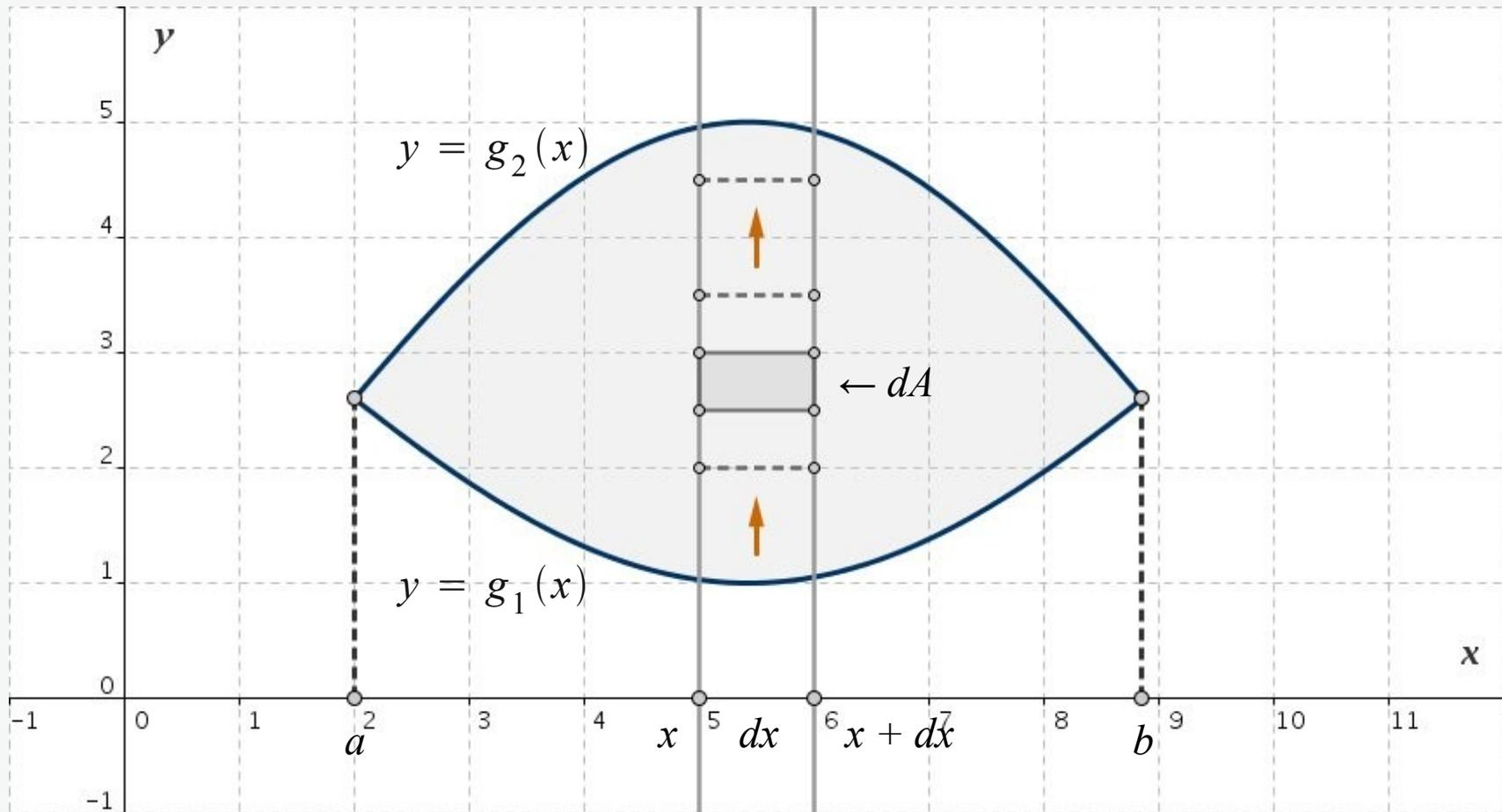
Abb. 6-2: Die über den Flächenelementen  $dA$  errichteten Säulen  $dV$  ergeben durch Summation über  $y$  eine Volumenschicht der Dicke  $dx$
