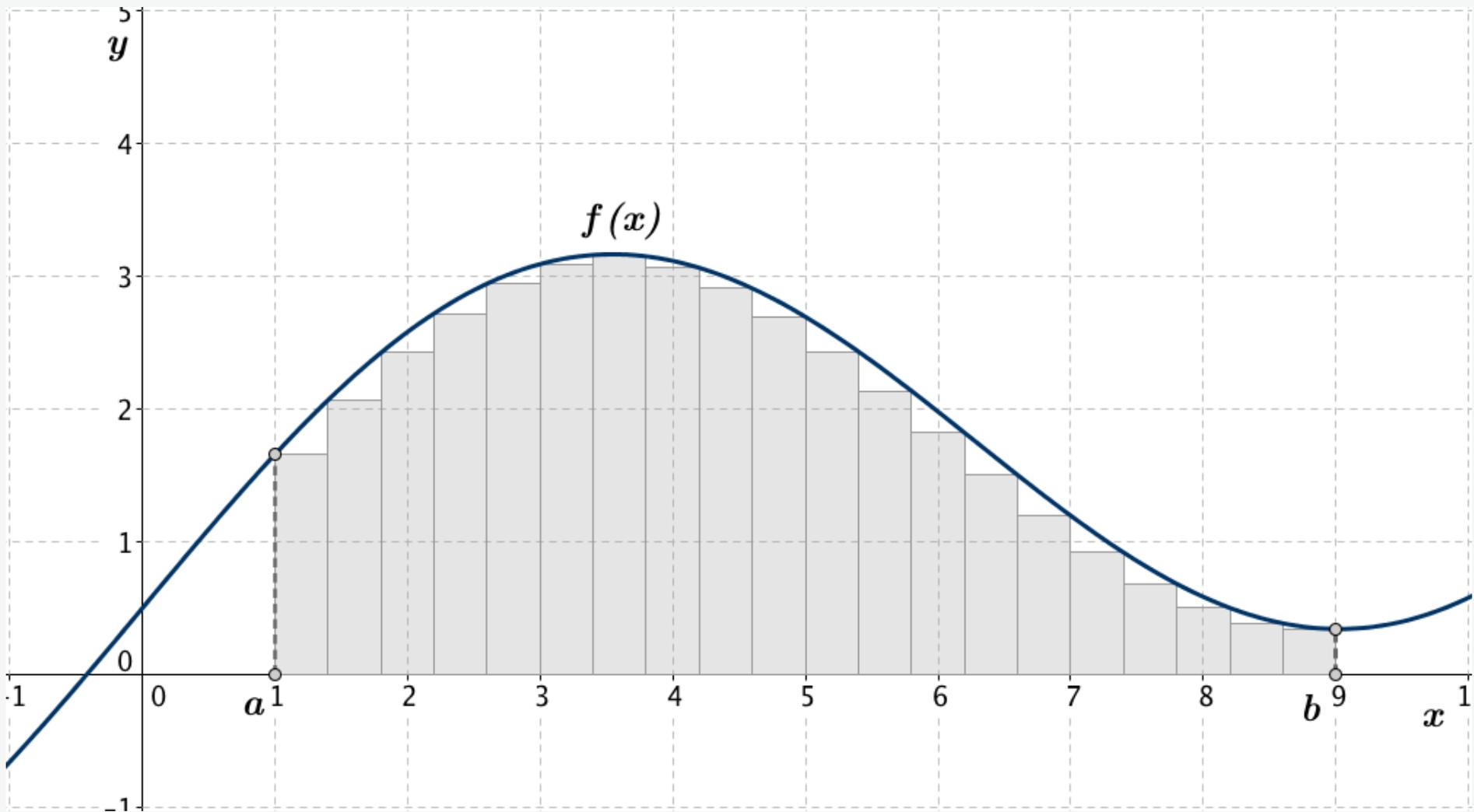
Abb. 2-2: Zur Bestimmung der Fläche zwischen der Funktion  $y = f(x)$  und der  $x$ -Achse im Intervall  $[a, b]$  ( $n = 20$ , Untersumme)
