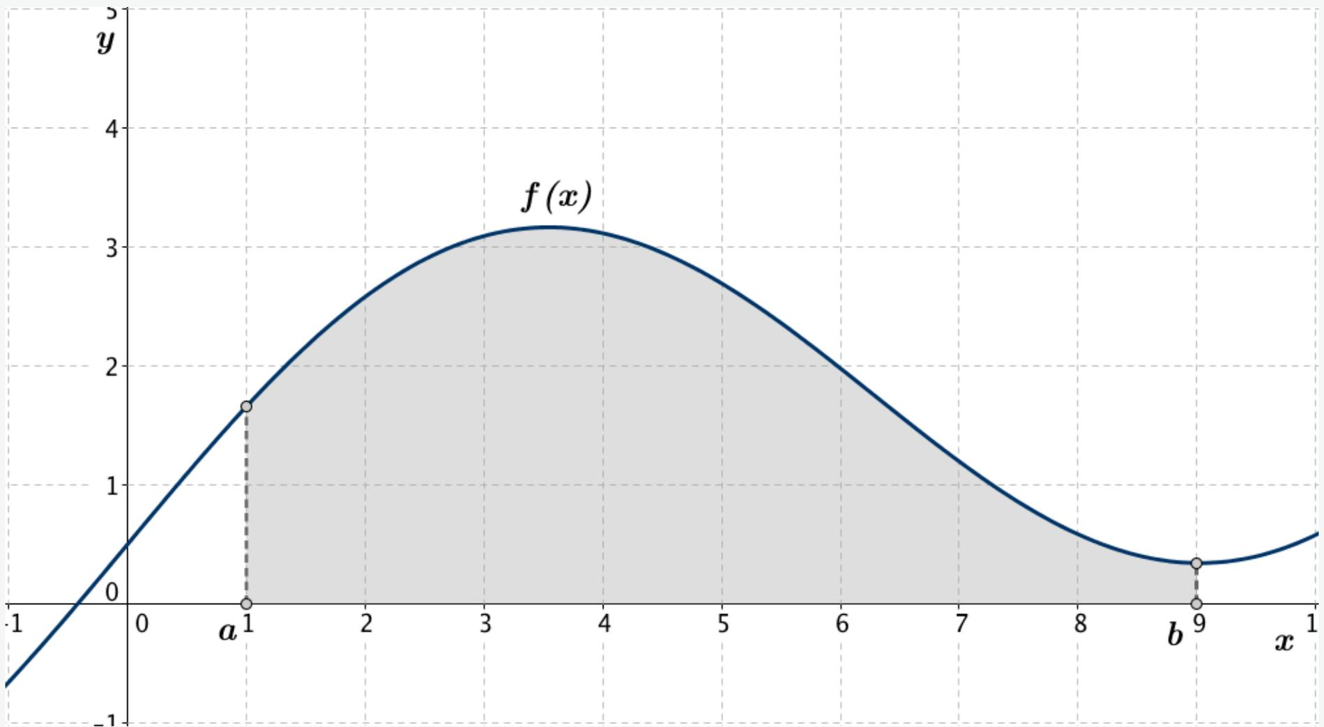
Abb. 2-1: Fläche zwischen der Funktion  $y=f(x)$  und der  $x$ -Achse im Intervall  $[a, b]$
