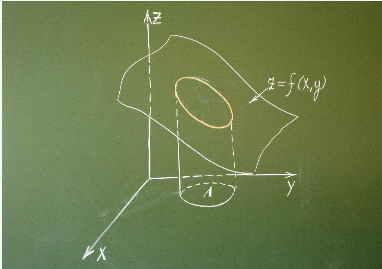
Abb. 3: Zylindrischer Körper mit der "Deckelfläche  $z = f(x, y)$ "
