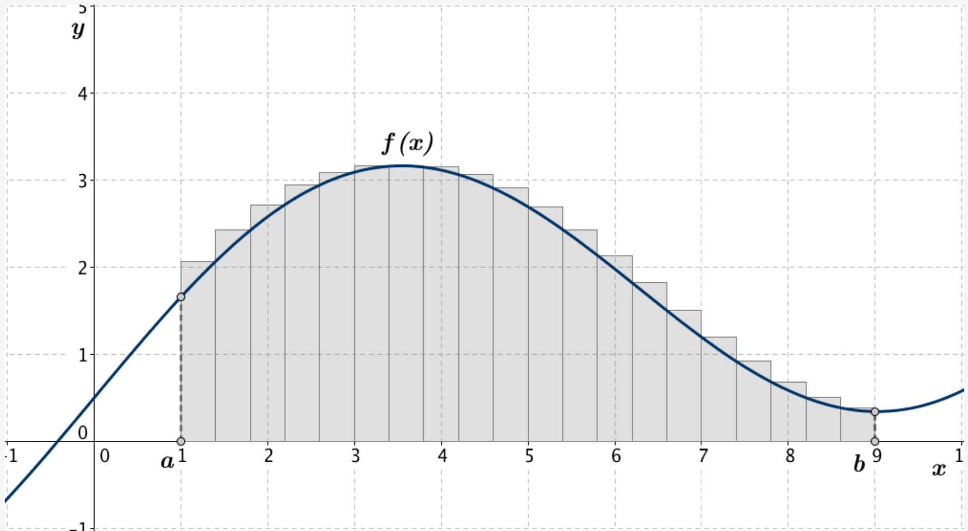
Abb. 2-3: Zur Bestimmung der Fläche zwischen der Funktion  $y = f(x)$  und der  $x$ -Achse im Intervall  $[a, b]$  ( $n = 20$ , Obersumme)
