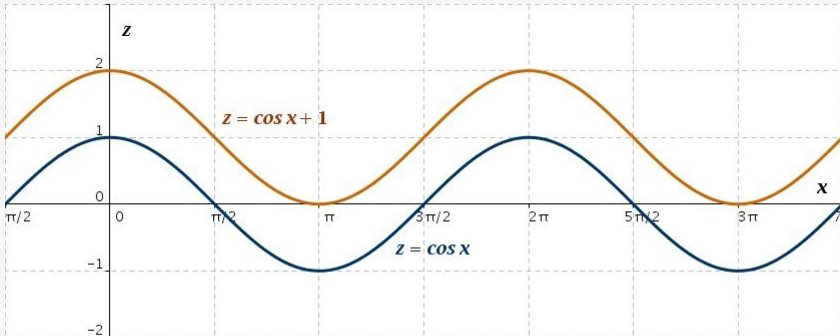
Abb. 7-3: Die Schnittkurven der Funktion  $f(x, y) = \cos x + \cos y$  mit der  $z, x$ -Ebene ( $y = 0$ ,  $\cos y = 1$ , die Schnittkurve  $z = \cos x + 1$ ) und mit der Ebene  $y = \pi/2$  ( $y = \pi/2$ ,  $\cos \pi/2 = 0$ , die Schnittkurve  $z = \cos x$ )
