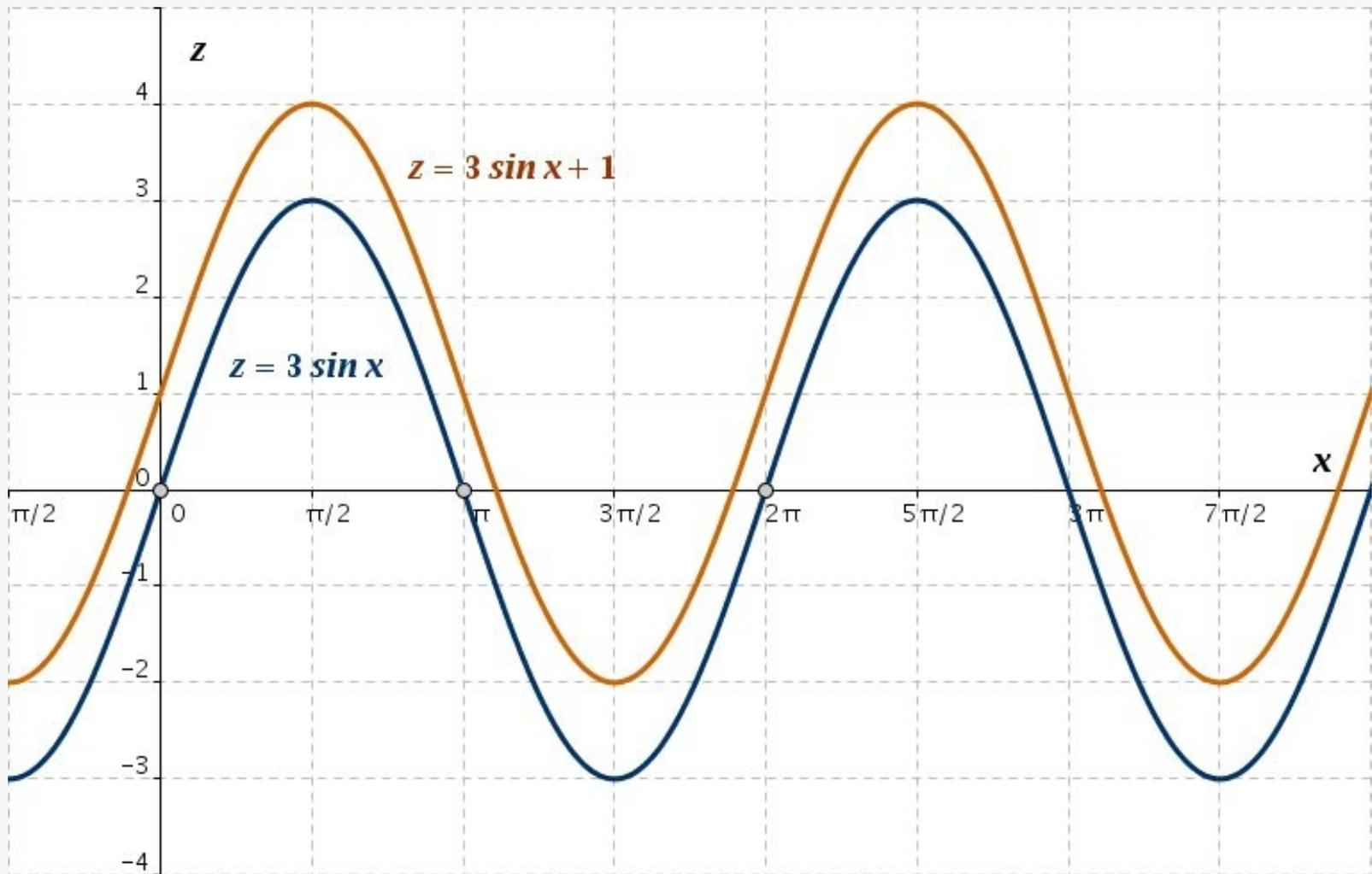
Abb. 11-3: Die Schnittkurven der Funktion  $z = f(x, y)$  mit der  $z, x$ -Ebene ( $y = 0$ , die Schnittkurve  $z = 3 \sin x$ ) und mit der Ebene  $y = 1$  (die Schnittkurve  $z = 3 \sin x + 1$ )
