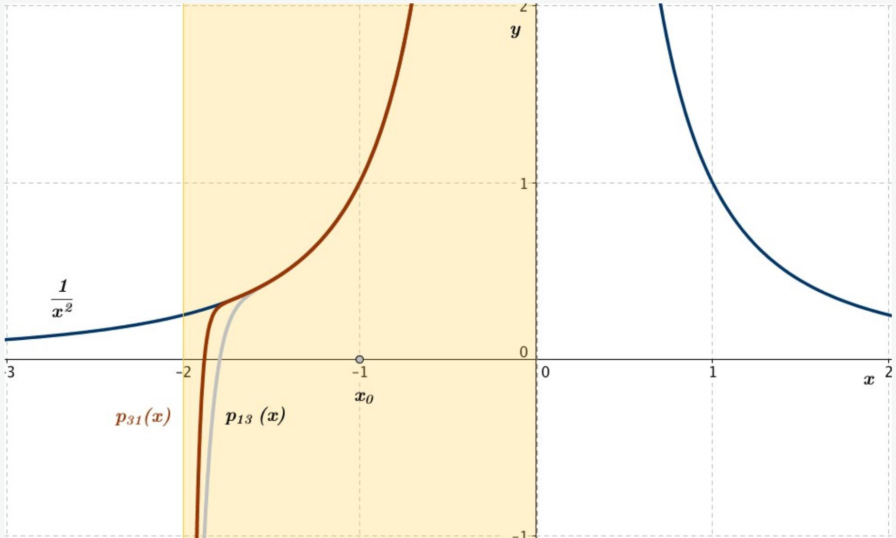
Abb. L4-2: Die Funktion  $f(x) = 1/x^2$  und Näherungspolynome 13. und 31. Grades. Der Entwicklungspunkt ist  $x = -1$ , der Konvergenzradius  $r = 1$
