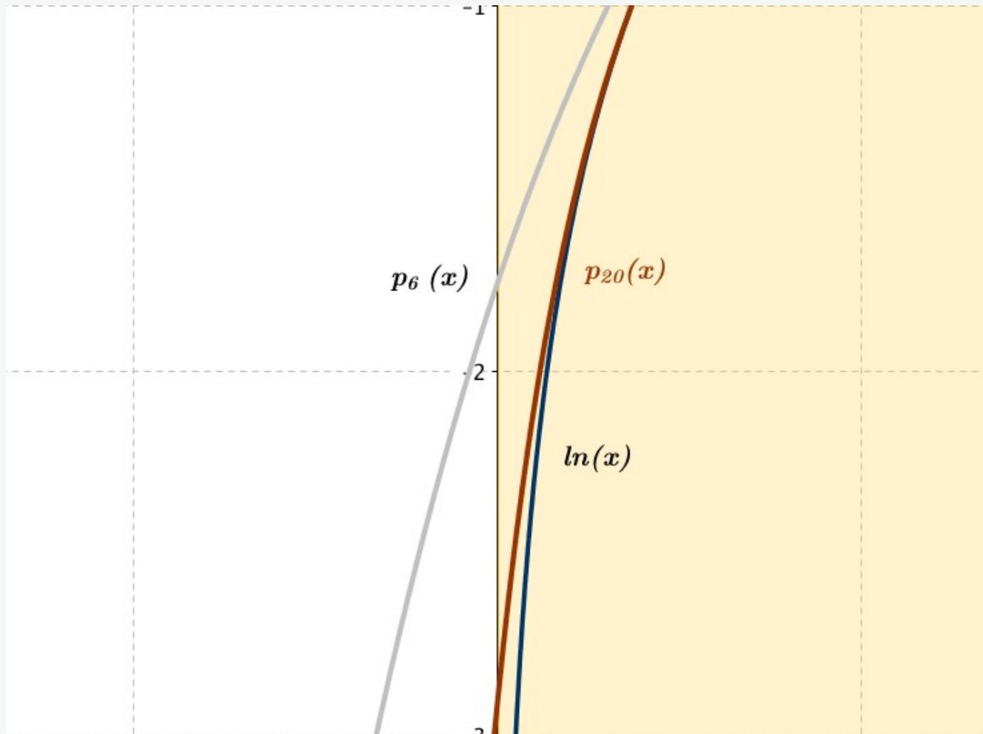
Abb. L2-3: Die Funktion  $f(x) = \ln x$  (blaue Kurve) und Näherungspolynome 6. und 20. Grades (entsprechend graue und rote Kurven) im Bereich  $-1.3 \leq x \leq 1.3$
