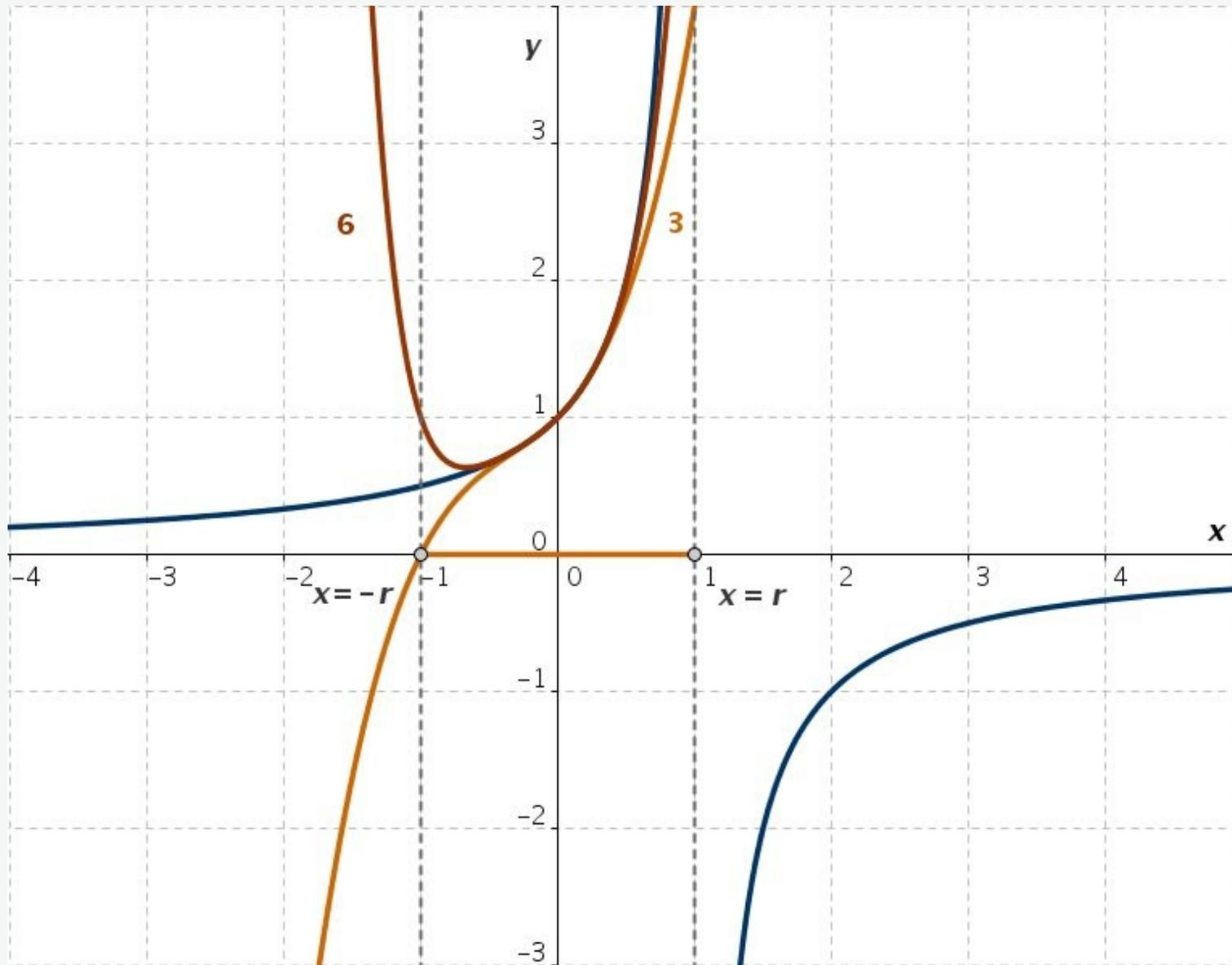
Abb. 2-3: Gebrochenrationale Funktion  $f(x) = 1/(1-x)$  und Näherungspolynome 3. und 6. Grades
