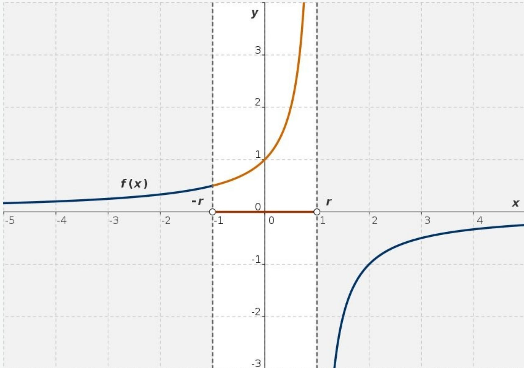
Abb. 2-1: Gebrochenrationale Funktion  $y = 1/(1-x)$ . Im Interval  $-1 < x < 1$  kann diese Funktion als Potenzreihe dargestellt werden
