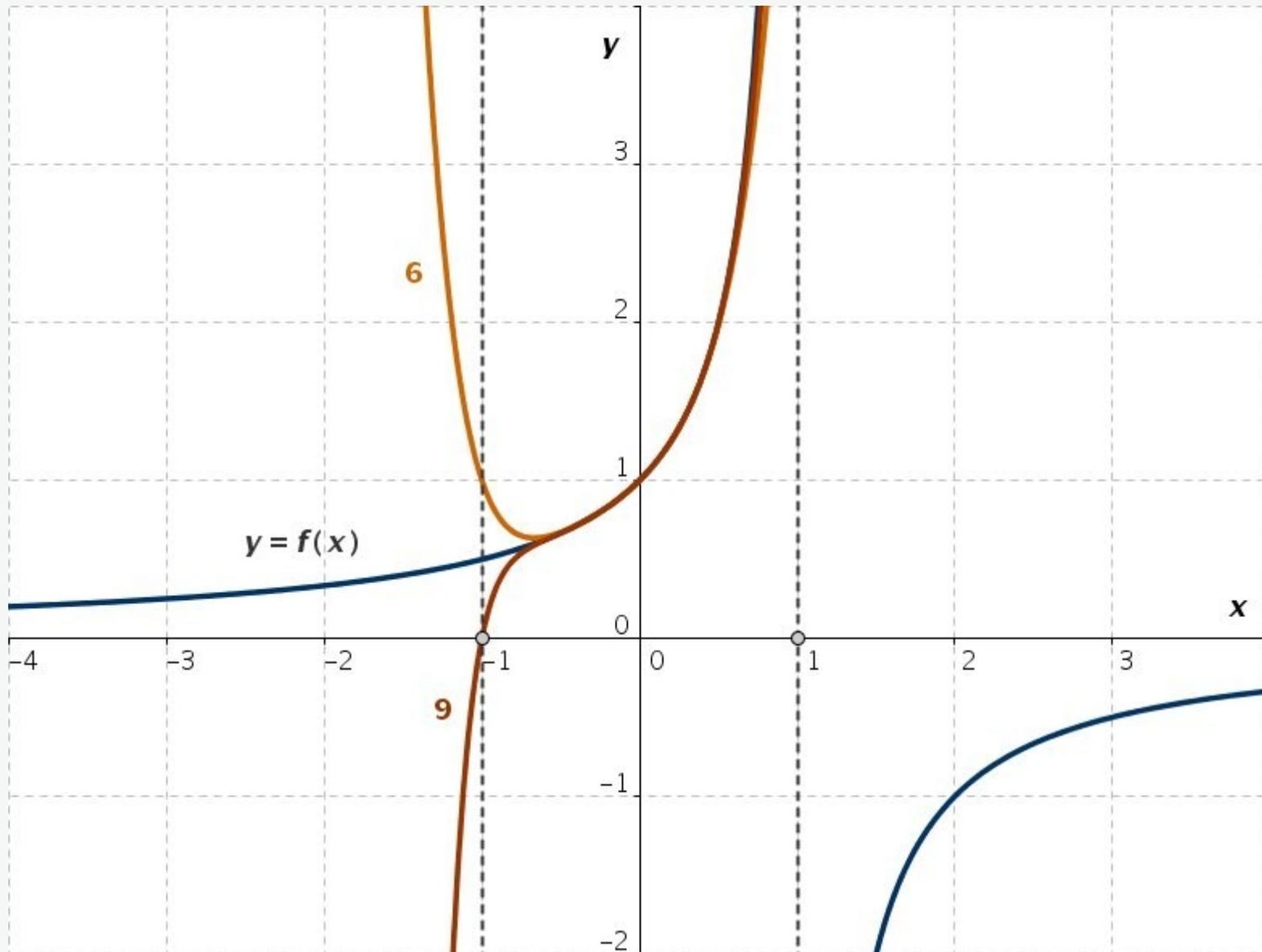
Abb. 2-4a: Gebrochenrationale Funktion  $f(x) = 1/(1-x)$  und Näherungspolynome 6. und 9. Grades
