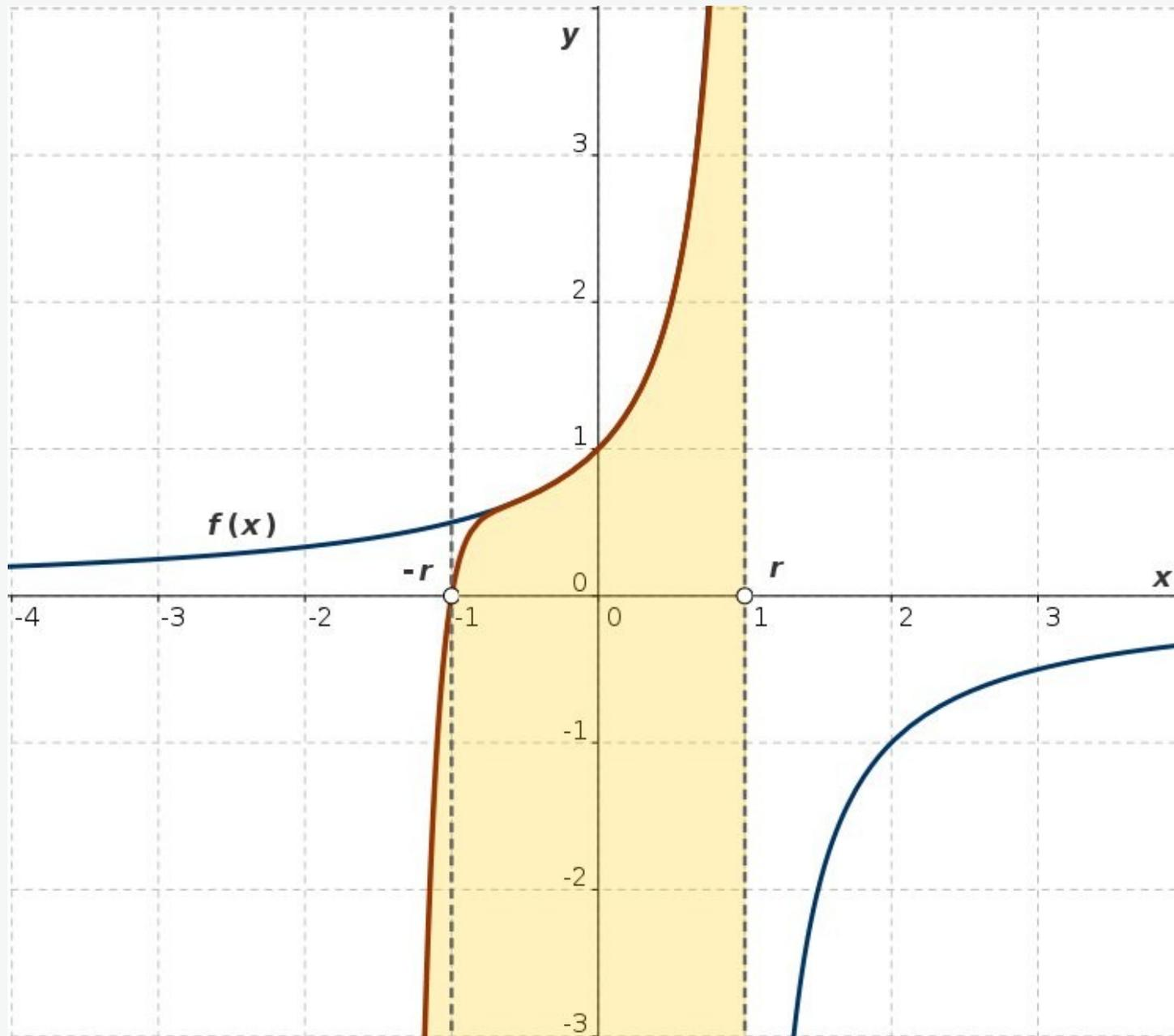
Abb. 2-5: Gebrochenrationale Funktion  $f(x) = 1/(1-x)$  und Näherungspolynome 11. Grades
