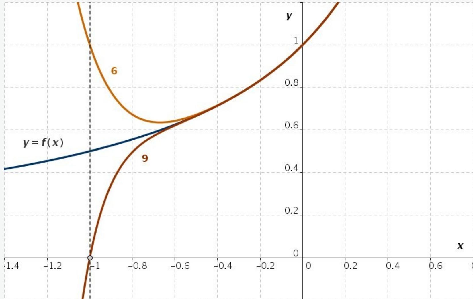
Abb. 2-4b: Gebrochenrationale Funktion  $f(x) = 1/(1-x)$  und Näherungspolynome 6. und 9. Grades
