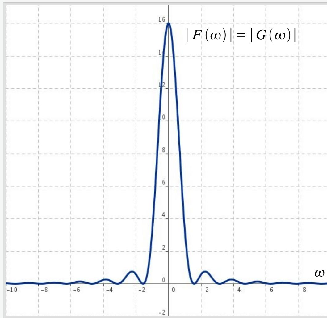
$$\text{Die Gleichung } f(t-T) \rightarrow G(\omega) = e^{-i\omega T} F(\omega)$$
