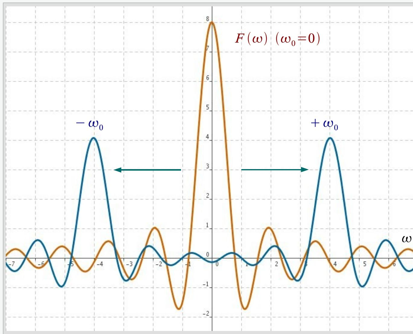
Die Amplitudenmodulation des Rechtecksignals entspricht einer Verschiebung des Spektrums um die Modulationsfrequenz  $\omega_0$  nach rechts und links.
