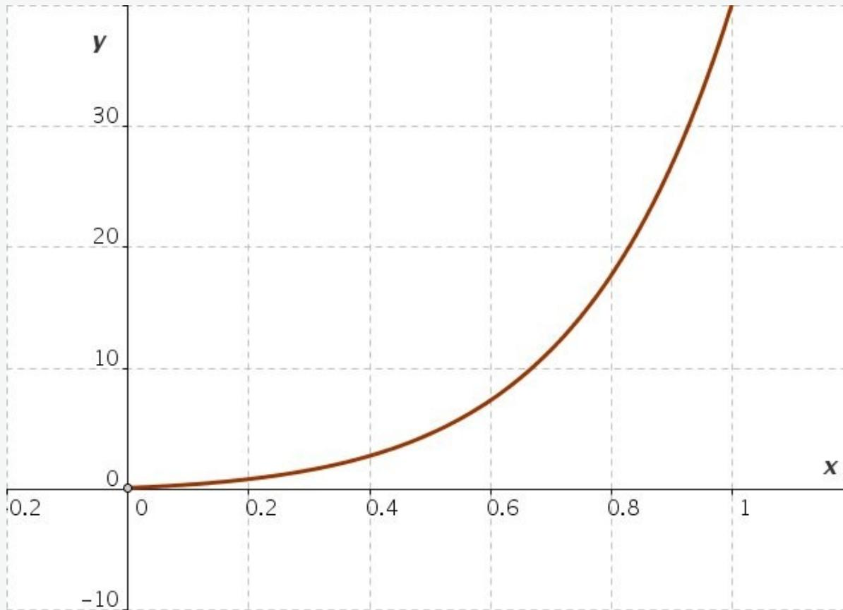
Abb. L3-1: Integralkurve der DGL  $y'' - 6y' + 9y = 0$ , die dem Anfangswertproblem  $y(0) = 0$ ,  $y'(0) = 2$  entspricht
