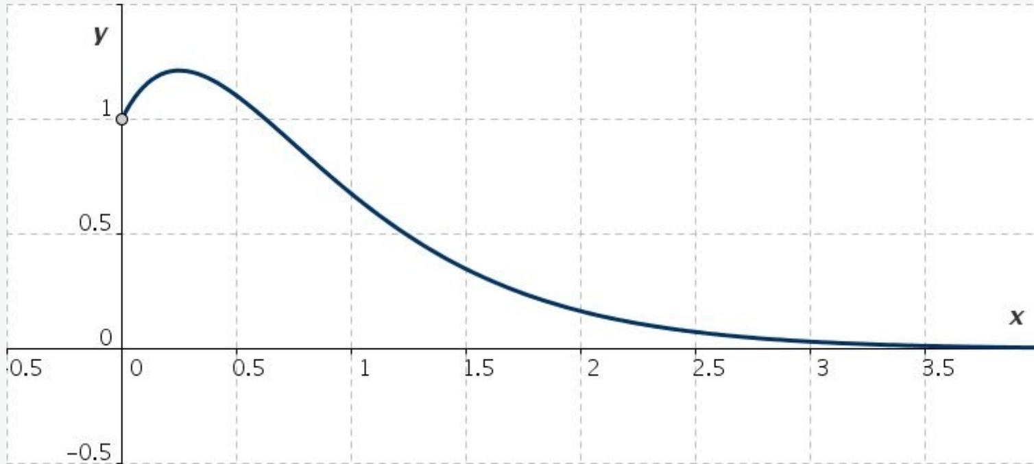
Abb. L1-1: Integralkurve der DGL  $y'' + 4y' + 4y = 0$ , die dem Anfangswertproblem  $y(0) = 1$ ,  $y'(0) = 2$  entspricht
