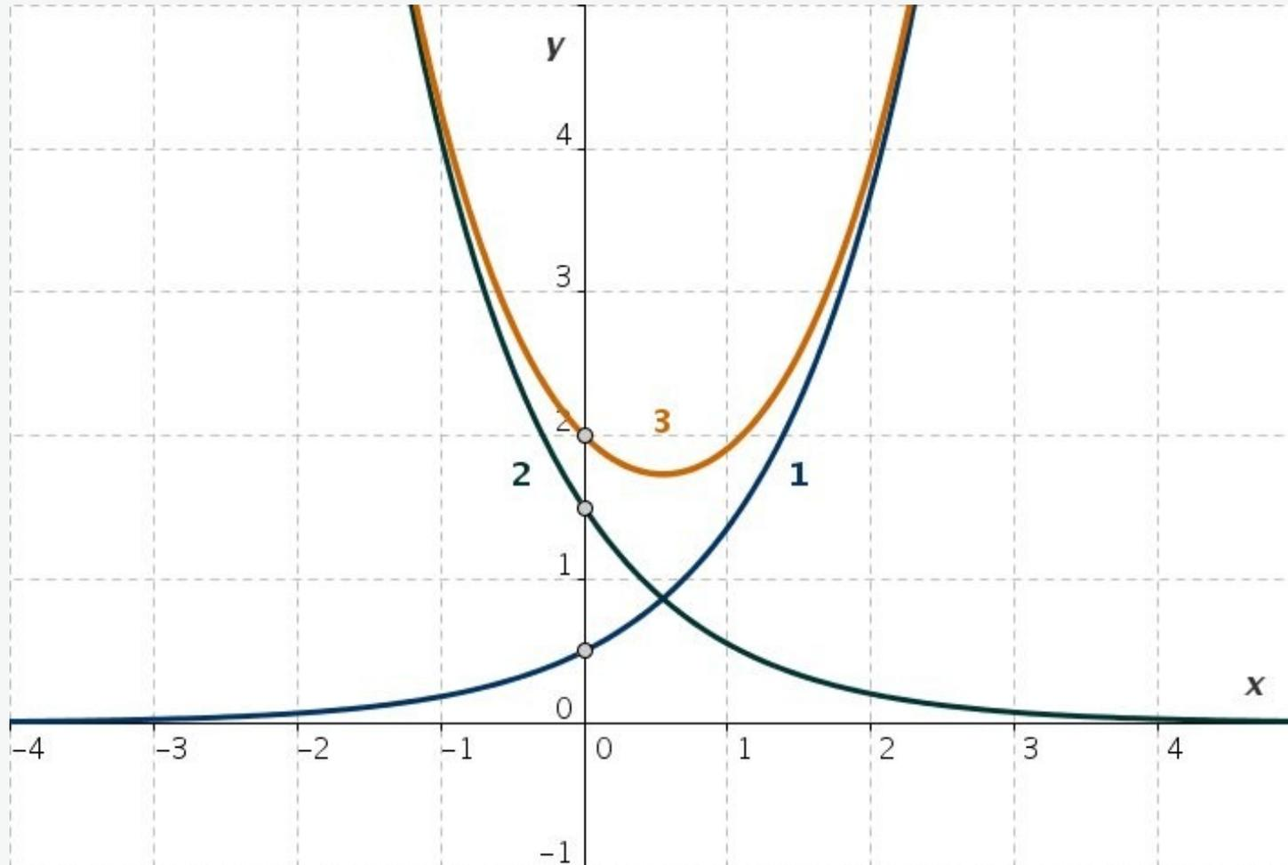
Abb. B2: Drei spezielle Lösungen der DGL 2. Ordnung  $y'' - y = 0$
