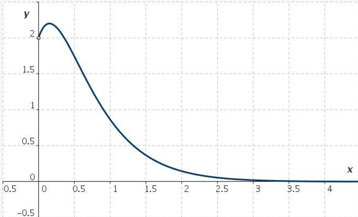
Abb. L4-1: Integralkurve der DGL  $y'' + 5y' + 6y = 0$  mit  $y(0) = 2$ ,  $y'(0) = 3$
