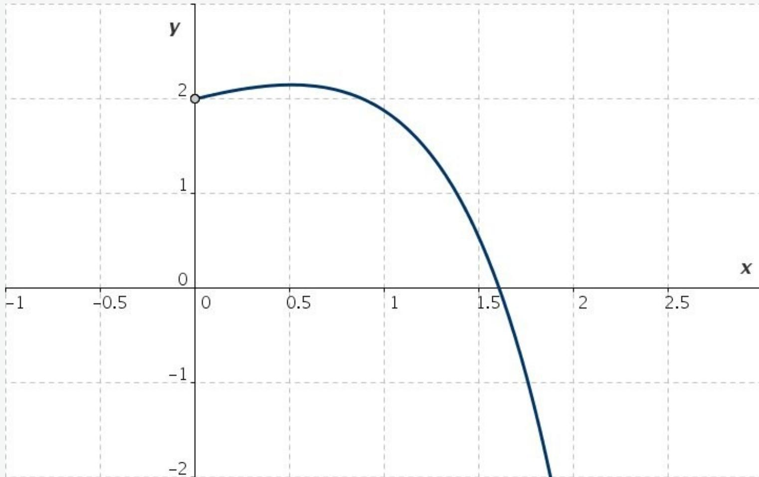
Abb. L5-1: Integralkurve der DGL  $4y'' - 8y' + 3y = 0$  mit  $y(0) = 2$ ,  $y'(0) = 1/2$
