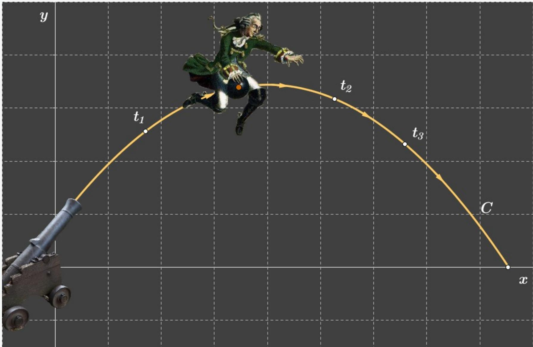
Abb. 1-3: Der schiefer Wurf. Flugpositionen zu verschiedenen Zeiten  $t$ . Die Pfeile geben die Richtung der Bewegung (= die Orientierung der Kurve  $C$ ) an.
